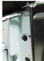
Entfernen Sie die Abdeckung des USB Schachts auf der Rückseite des Geräts. Geben Sie gut acht auf die Schrauben, diese werden in einem nächsten Schritt benötigt. Bewahren Sie bitte außerdem die Abdeckung gut für eine eventuelle spätere Verwendung auf.
