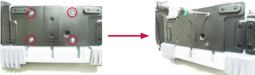
Entfernen Sie die 4 Schrauben, welche die Tasche an der Unterseite des Geräts fixieren.
