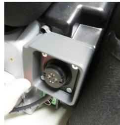
Nehmen Sie den LP15 Power Adapter und platzieren Sie ihn auf dem USB Schacht, wie im Bild oben dargestellt. Achten Sie auf einen sauberen Sitz des Adapters, dieser kann leicht an der Tasche verkanten.
