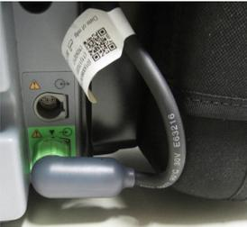
Verbinden Sie nun den Winkelstecker mit der Eingangsbuchse des Geräts.
