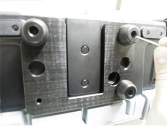
Legen Sie die je eine der beigestellten Unterlegscheiben in die mitgelieferten Kunststofffüße ein und verschrauben Sie die Adaption w/o power anschließend mit den beigestellten Schrauben an der Unterseite des Geräts.
