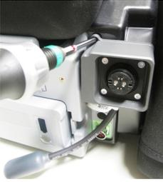
Befestigen Sie nun den LP15 Power Adapter am Gerät. Nutzen Sie hierfür bitte die Schrauben, mit denen die Abdeckung des USB Schachts befestigt war.
